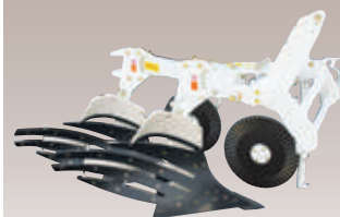
格子ボトム オフセット機構
