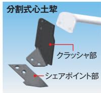
プラウ耕と同時に鍬床を破碎・膨軟にして、作土層を拡大します。根の生育が旺盛になり、排水を促します。また、下層土の改良・改善ができて、タイヤの踏圧も解消します。さらに、クラッシュャ部・シエアポイント部交換式の分割式心土犁もあります。
