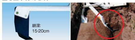
プラウ耕と同時に鋤床を破碎・膨軟にして、作土層を拡大します。根の生育が旺盛になり、排水を促します。また、下層土の改良・改善ができ、タイヤの踏圧も解消します。さらに、クラッシュ部・シェアポイント部交換式の分割式心土犁もあります。
