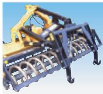
播種機を取付けるための外付け3点ヒッチです。油圧で持ち上げることができます。\*トラクタ外部油圧取出し1系統が必要です。\*取付け3P規格の装着装置の種類は3点リンク2形です。\*カブラサイズ=1/2オス 1/2オス用カブラ=2個\*トラクタに外部油圧取出しが必要です。\*ローラー油圧跳ね上げと一緒に取付けできません。
