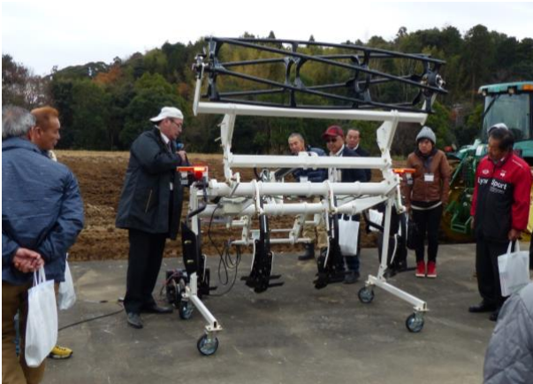
スタブルカルチ道路走行対応試作アタッチメントとスガノ農機製スプリングハロー
