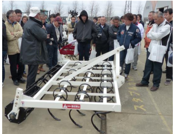
スタブルカルチ道路走行対応試作アタッチメントとスガノ農機製スプリングハロー
