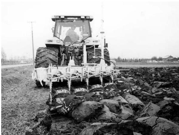
写真 4 レーザーブラウ反転均平 工法に使用
